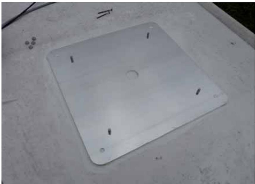
Foto sopra: si studia il corretto posizionamento dell'antenna satellitare sul tetto del camper; Foto sotto: si presenta la piastra di ancoraggio sul tetto, valutando bene lo spazio disponibile anche per il corretto movimento dell'antenna
