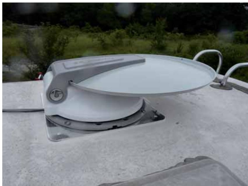
Foto sopra: si silicona la piastra di ancoraggio al tetto;
