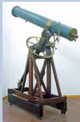
Telescopio a riflessione con montatura equatoriale
